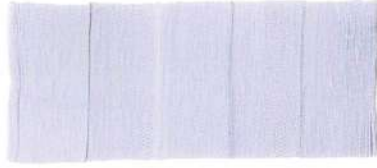
▲注入用ウエスパッキン
